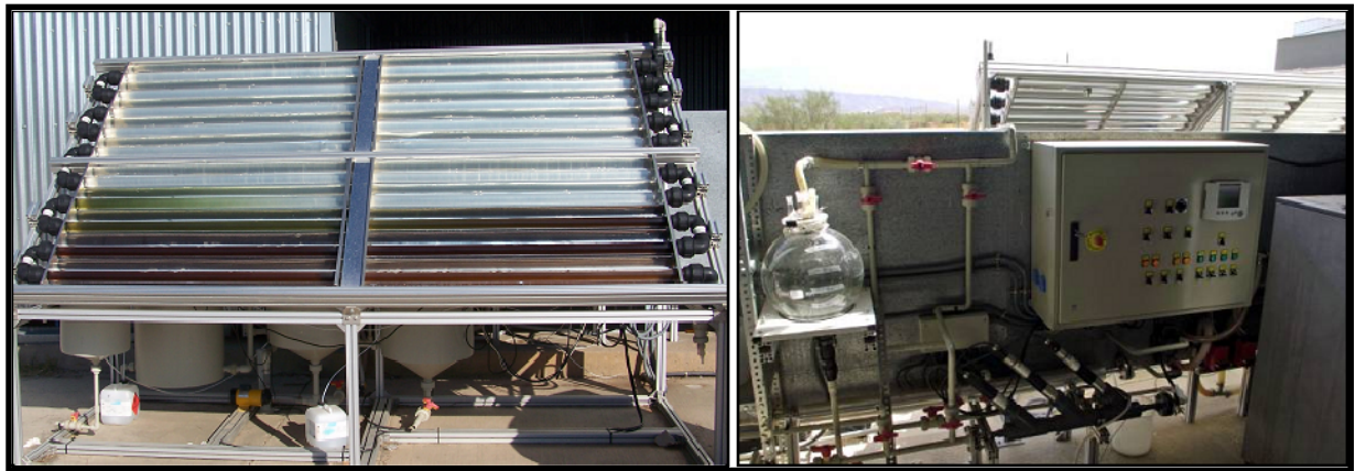
Figura 6. Fotografía de los cuatro módulos de concentradores CPC durante un ensayo de foto-Fenton (izda.) e interior de la caseta que protege al tanque de recirculación, los sensores, el sistema de calefacción y refrigeración y el cuadro eléctrico (dcha.).
